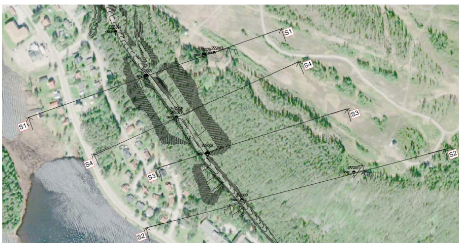
Figur 5. Planritning över upprättade beräkningssektioner för stabilitetsberäkning. I bakgrunden kan flygfoto från Bing-kartor ses, hämtad 2025-10-01. Svarta täta linjeringer inom planområdet utgörs av projekterade slänter för tomter från interna projektörer.
